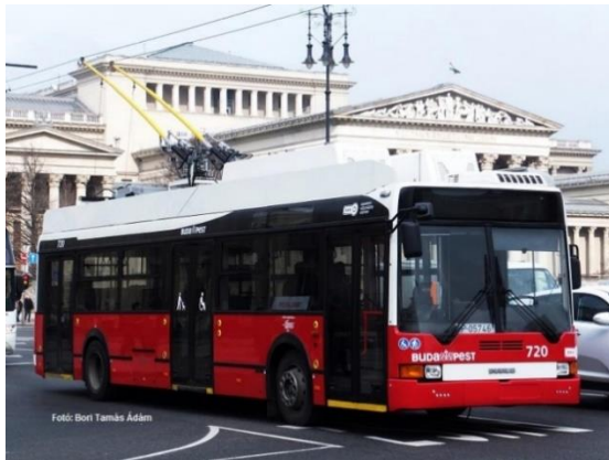
34. ábra - Átépített, korábban dízel hajtású trolibusz[21]
